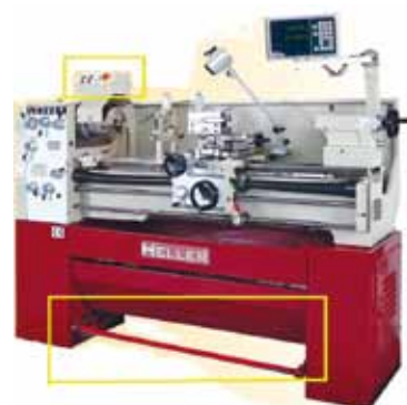
Figura 19. Torno con parada y freno de emergencia (Fuente: Heller).
