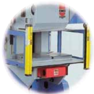
Figura 17. Barrera de seguridad (Fuente: EMGpresses).
