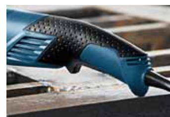
Figura 6. Amoladoras con zonas de agarre antideslizantes y cuerpo estrecho (Fuentes: Hilti, Bosch).
