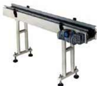
Figura 8. Transportador de banda estrecha para la evacuación de piezas (Fuente: Renzo borgonovo).
