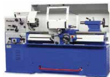
Figura 13. Torno convencional con diferentes tipos de empuñaduras (Fuente: Pinacho).
