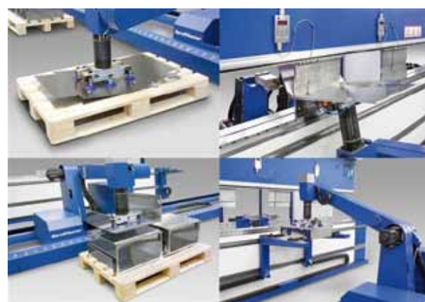
Figura 5. Sistema de manutención de piezas robotizadas (Fuente: Trumpf).
