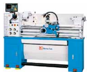
Figura 18. Torno con mandos manuales y con dispositivo de visualización electrónica (Fuente: Knuth).
