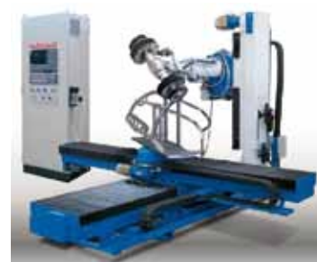
Figura 8. Pulidora CNC con cabezal doble y mesa para piezas de grandes dimensiones (Fuente: Autopulit).
