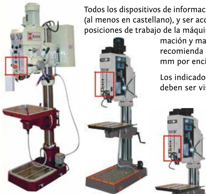
Figura 13: situación de la parada de emergencia (Fuentes: Heller y Wilton).
