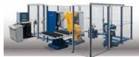
Figura 10. Célula robot con dos unidades de lijado, una de pulido, virador de pieza y almacén (Fuente: Autopulit).
