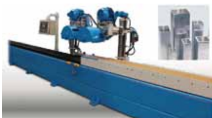
Figura 2. Lijadora para perfiles y piezas planas largas (Fuente: Autopulit).
