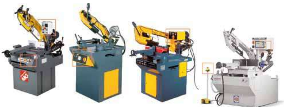
Figura 17. Diferentes localizaciones de la parada de emergencia (Fuentes: MG, Thomas).
