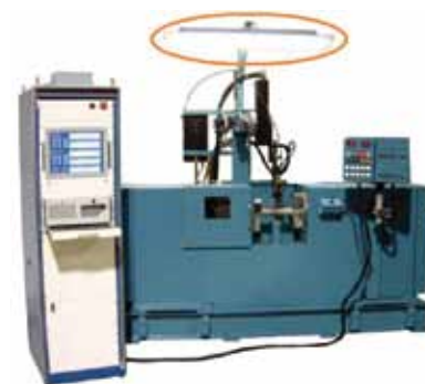
Figura 7. Soldadora con iluminación localizada (Fuente: Jetline).
