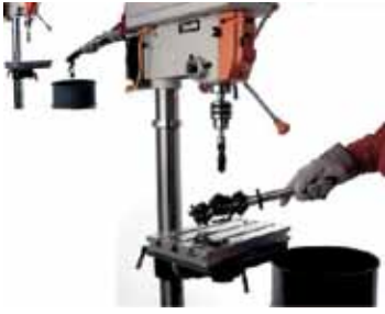
Figura 16. Accesorio magnético para la limpieza y recogida de virutas (Fuente: Bessey).
