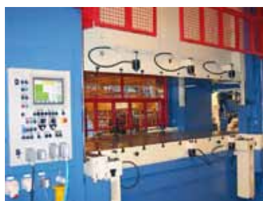
Figura 13. Sujeción rápida del troquel (Fuente: Arisa).
