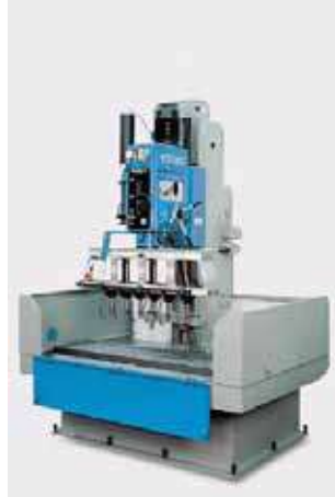
Figura 9. Taladro con mesa extralarga (Fuente: Ibarmia).
