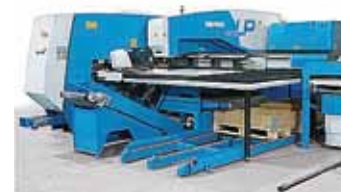
Figura 1. Máquina que integra cizalla y punzonadora (Fuente: Finnpower).
