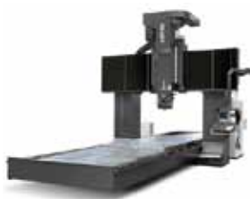
Figura 7. Centro de mecanizado con mesa móvil (Fuentes: Anayak, Milltronics).
