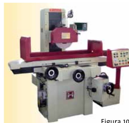
Figura 10. Rectificadora con parada de emergencia (Fuente: Heller).
