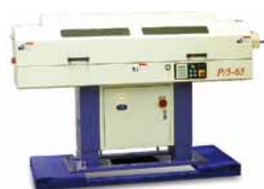
Figura 12. Alimentador de barras automático (Fuente: Pinacho).
