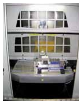
Figura 5. Detalle de la mesa pendular (Fuente: Ibarmia).
