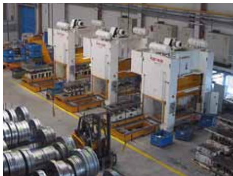
Figura 9. Sistemas para la introducción rápida del troquel (Fuente: Arisa).
