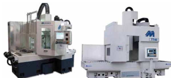
Figura 4. Centros de mecanizado con sistema de carga en marcha (Fuente: Milltronics).
