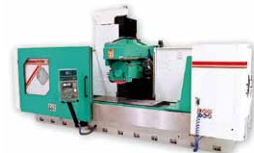
Figura 2. Rectificadora con puerta frontal y ventanas (Fuente: Rosa Ermando).
