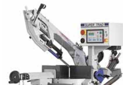
Figura 15. Tronzadora con dispositivo de visualización (Fuente: Thomas).
