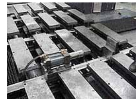
Figura 8. Línea láser móvil y mordaza hidráulica con tope (Fuente: Danobat).
