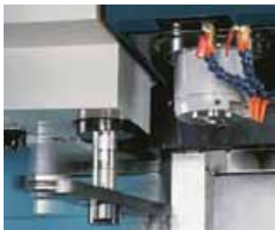
Figura 7. Cambiador automático de herramientas (Fuente: Famasa).
