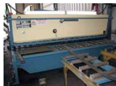
Figura 12. Accesorios de conducción, patín y rodillos (Fuente: Promecam).
