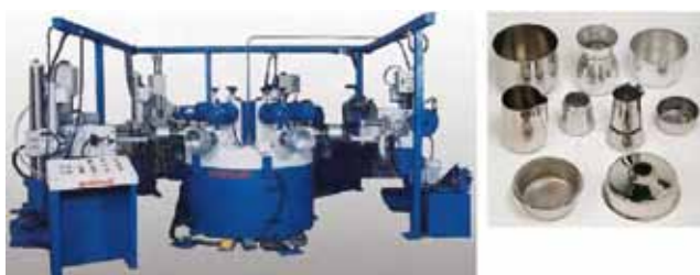
Figura 13. Lijadora para ollas y cacerolas (Fuente: Autopulit).
