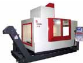
Figura 16. Centro de mecanizado con dos ventanas laterales (Fuente: Kondia).
