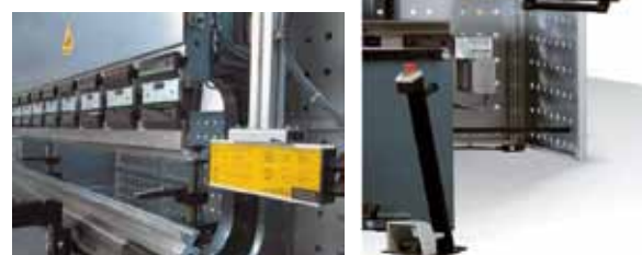
Figura 6. Plegadora con varios sistemas de seguridad (Fuente: Durma).
