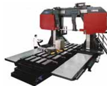
Figura 12. Sierra tronzadora tipo pórtico para grandes formatos (Fuente: Danobat).
