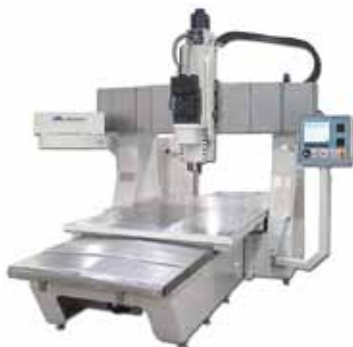
Figura 7. Centro de mecanizado con mesa móvil (Fuentes: Anayak, Milltronics).
