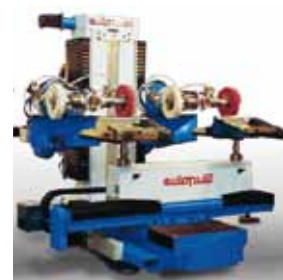
Figura 7. Pulidora CNC para el acabado de dos piezas simultáneamente (Fuente: Autopulit).
