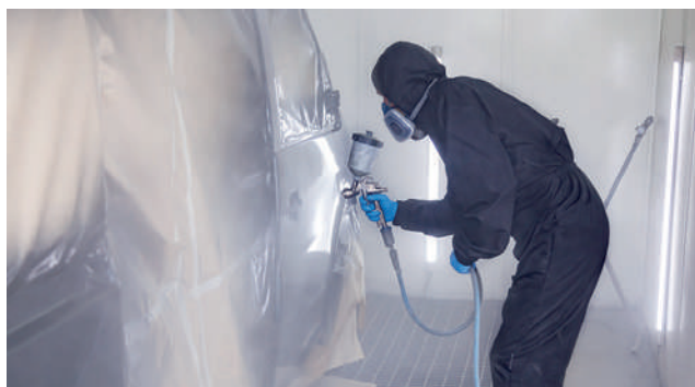
Figura 3. Uno de los procesos donde es normal la formación de nieblas es pintura por proyección. Si esta pintura o sus disolventes son inflamables, se podría formar una ATEX.
