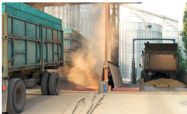
Figura 18. La extensión de la zona clasificada por nube de polvo se puede determinar por simple observación.
