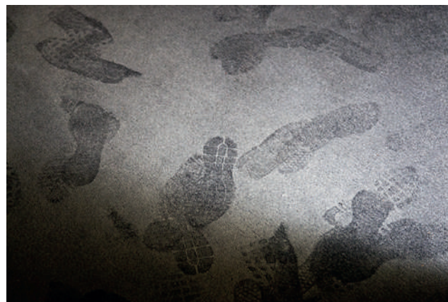
Figura 6. La existencia de capas finas de polvo depositado pueden ser suficientes para formar una atmósfera explosiva peligrosa. Cuanto más fino y seco sea el polvo inflamable, mayor peligrosidad. El polvo depositado debe ser eliminado.
