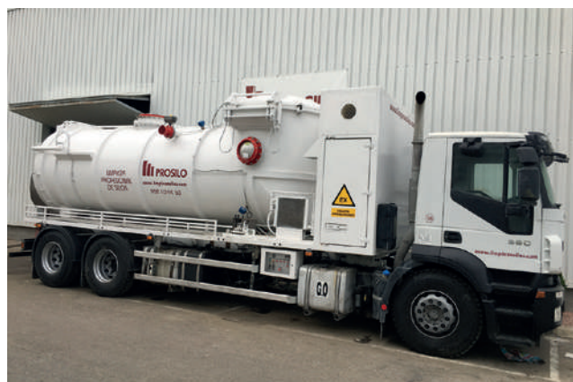
Figura 29. Camión aspirador ATEX con armazon ignífugo.
