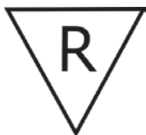
Figura 28. Símbolo de equipo reparado que UNE EN 60079-19: 2011 pero no necesariamente con el certificado y/o especificaciones del fabricante.
