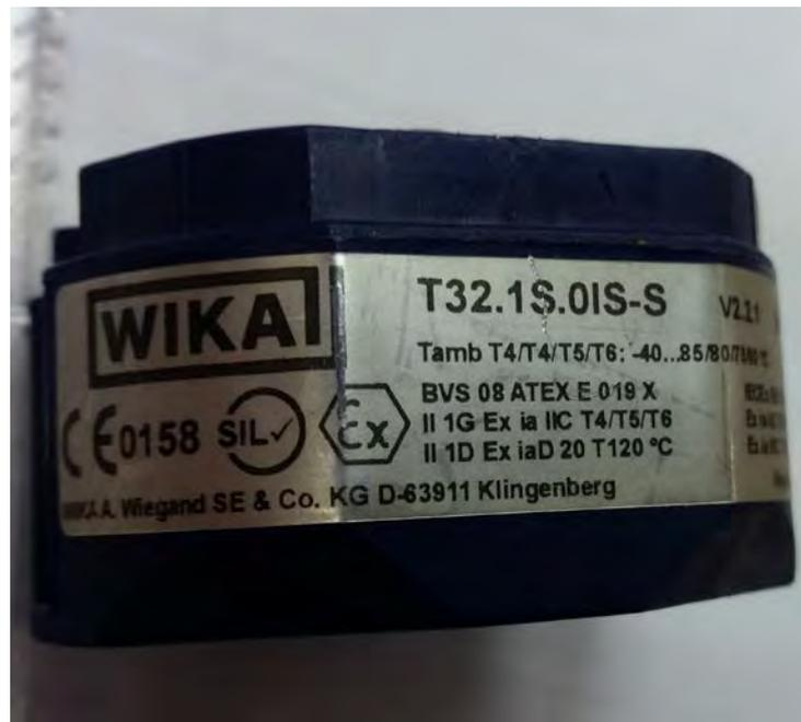
Como mínimo deberíamos comprobarlo en la placa de marcado del equipo aunque es recomendable que se haga esa comprobación en el certificado del equipo.
