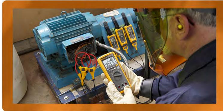
La resistencia de aislamiento es medida entre los conductores activos y el conductor de protección conectado a tierra. Durante este ensayo los conductores activos pueden estar conectados eléctricamente entre ellos. La tensión continua de medida y la resistencia de aislamiento tienen que cumplir con las exigencias de la siguiente tabla.
