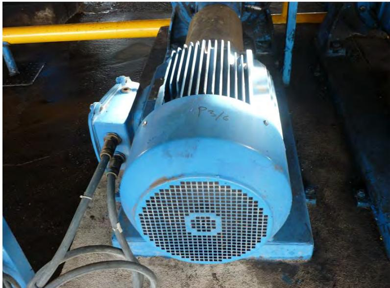
De igual modo hay que prestar especial atención a la estructura de fijación que tenga el motor. Debido a las vibraciones que aparecen en funcionamiento normal pueden aparecer grietas que afecten negativamente a su funcionamiento.
