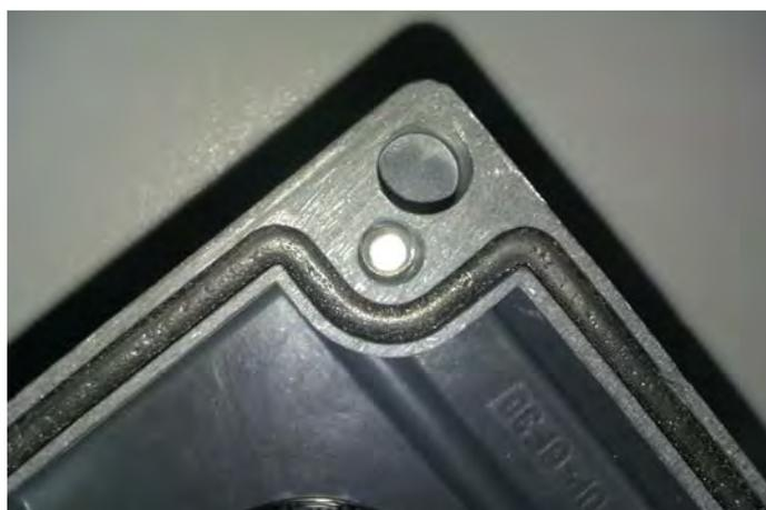
**15.- No hay ninguna prueba de entrada de agua o polvo en la envolvente de acuerdo con el grado de protección IP**
