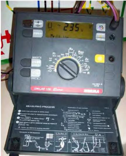
La medición hay que realizarla con instrumentos específicos para su uso en circuitos de seguridad intrínseca.
