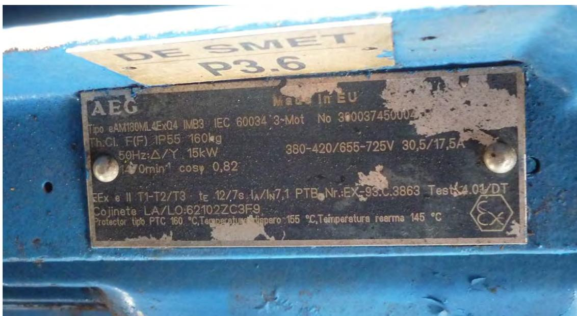
En este caso es necesario identificar, en la placa de características del motor, la relación  $I_A/I_N$ , relación entre la intensidad de arranque y la intensidad nominal del motor, y el tiempo  $t_E$ , que es el tiempo de corte de corriente del dispositivo.
