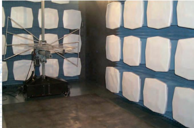
Cámara semianecóica para ensayos de Compatibilidad Electromagnética
